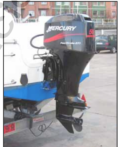
Motor fueraborda montado sobre el espejo de popa de una neumática.
