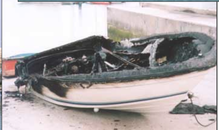
Resultado de un incendio al arrancar el motor después de hacer consumo, en el mismo pantalán del surtidor. Gijón-2004
